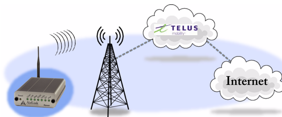
FIGURE 1. Utilisation du Raven-E pour se relier à l'Internet
